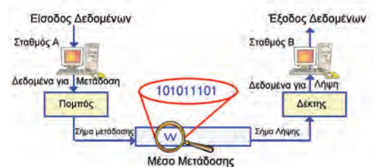
Εικόνα 4.3. Σύνδεση δύο υπολογιστών με καλώδιο
